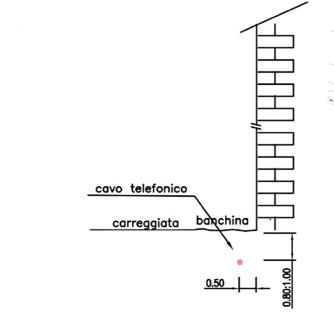
Sezione tipo di attraversamento
